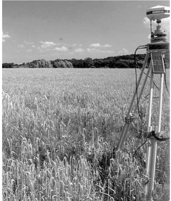
**Abbildung 3-1:** Leica SR 399 Referenzstation am Schlagrand Espenberg (GTW).
