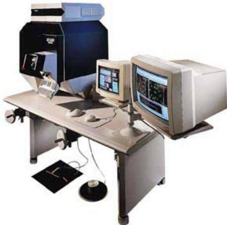
Analytischer Plotter LH Systems AM 2000 LH Systems SD 2000/3000 http://www.gis.leica-geosystems.com/
